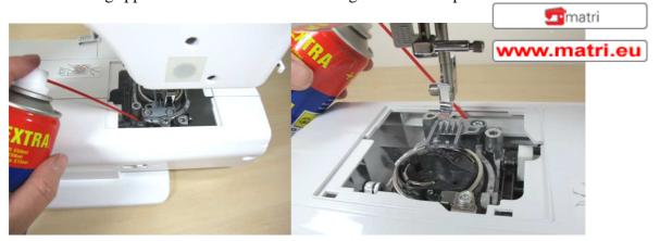
4. Poussez le bouton pour mettre les griffes dans la position haute en tournant le volant de la machine. Éventuellement, poussez le bouton plusieurs fois vers la droite et gauche. Pendant que vous tournez le volant vous devez entendre un clic quand les griffes se remettent dans la position haute. Parfois il faut pousser un peu plus sur le bouton.
